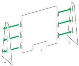
STEP 3: SLIDE PART B DOWN SO THAT THE BOTOM OF ALL PARTS ARE FLUSH
